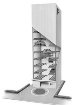
■機械式自動車駐車場
