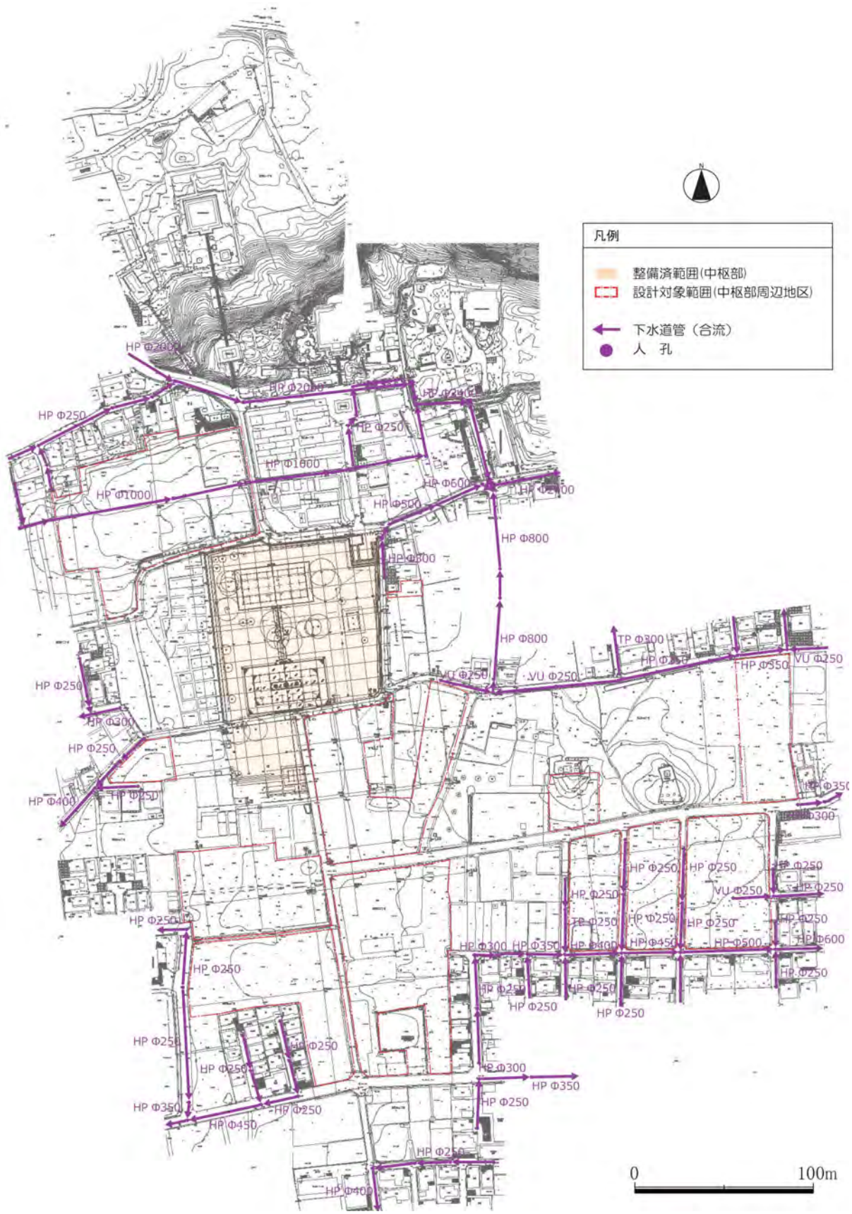
图 12 下水道設置状況图
