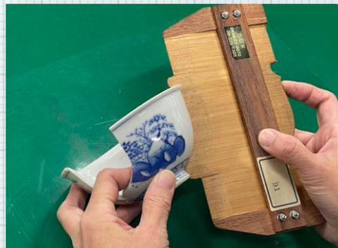
形状を図面に写し取るための道具／真弧
