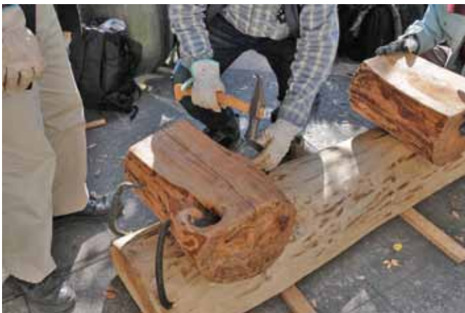
カスガイを打ち座面と脚部を固定する様子
