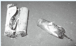
再資源化処理施設で発火したリチウム電池
