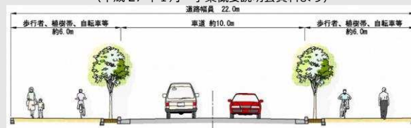
国3・4・12号線標準断面図（イメージ）
