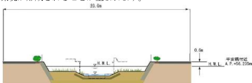
図5 計画標準断面図（野川、鞍尾根橋～不動橋の複断面河道整備）
